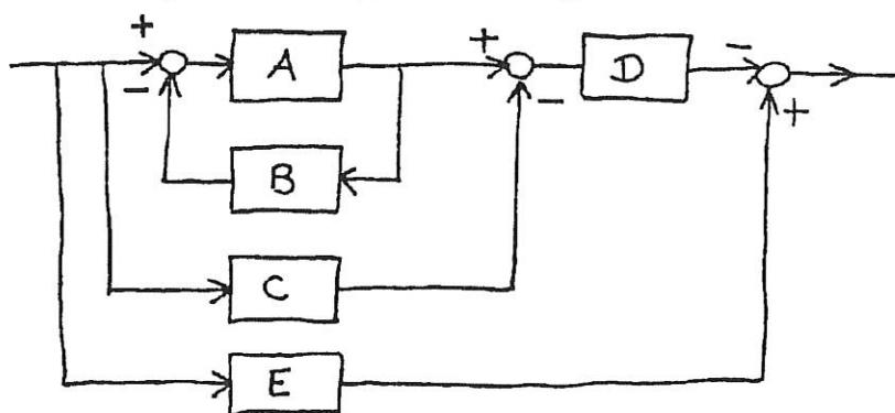
I blocchi A e B sono descritti dalle funzioni di trasferimento  $G_A(s) = \frac{10}{s-1}$ ,  $G_B(s) = \frac{s}{s-2}$ , il blocco C è descritto dal modello ingresso/uscita  $\ddot{y}_C + \dot{y}_C + 4y_C = -4\dot{u}_C + 2u_C$ , il blocco E è descritto dal modello di stato
