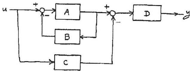
Il blocco A ha funzione di trasferimento  $G_A(s) = \frac{1}{s-1}$ , il blocco D è descritto dal modello I/O  $\dot{y}_D + 2y_D = -\dot{u}_D$ , il
