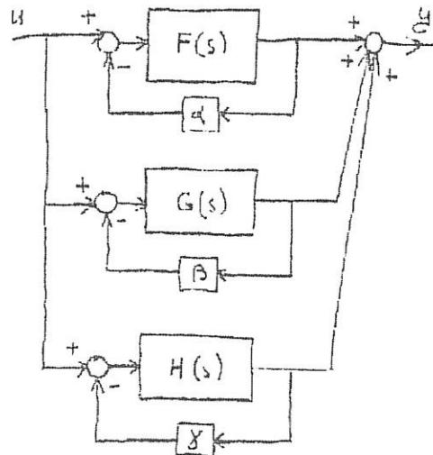
a) Determinare, motivando adeguatamente la risposta, per quali valori della terna  $(\alpha, \beta, \gamma)$  il sistema in figura è asintoticamente stabile.
